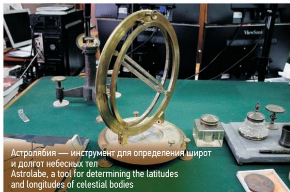
Астролябия — инструмент для определения широт и долгот небесных тел
